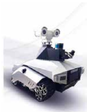
图3：变电站巡检机器人
