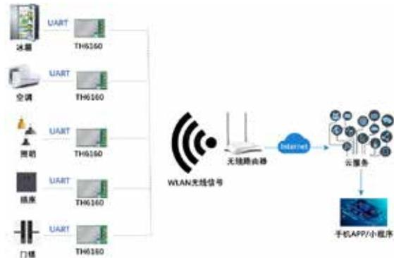
图：UART串口转WLAN透传模式应用示意图
