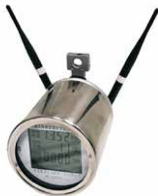
图：无源无线避雷器状态监测装置ISM-901S
