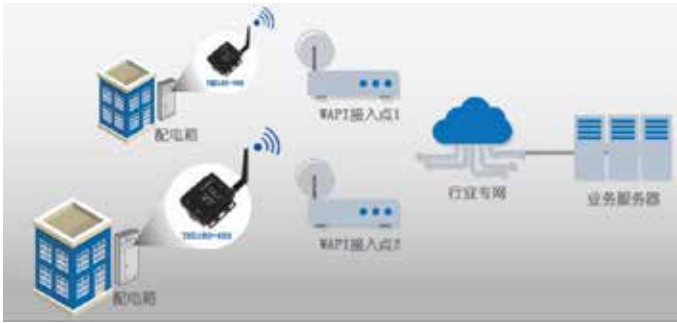
图：THD180-485 无线传输应用示意图
