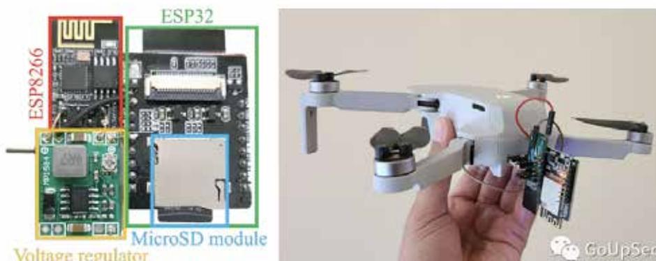
图2：Wi-Peep设备原型
