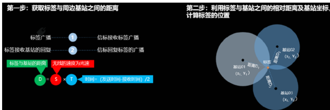
图：UWB技术的定位原理
