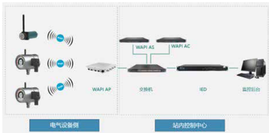
图：典型的WAPI无线通讯系统拓扑结构
